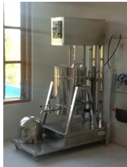
Gambar 2. Mesin Pengaduk Susu di Ruang Cooling STP Dilem Wilis Trenggalek
