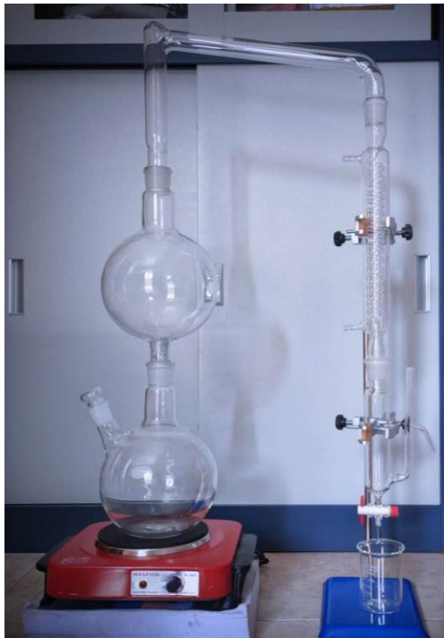
Gambar 4. Set Destilator Penyulingan
