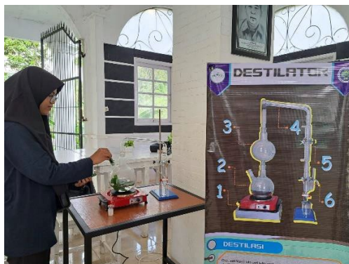
Gambar 5. Pengujian Destilator Penyulingan Minyak Atsiri
