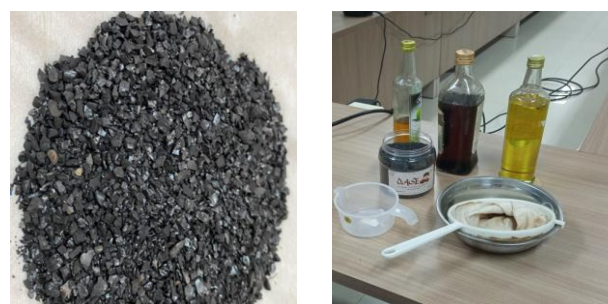
Gambar 5. Arang aktif dan minyak (jelantah, minyak baru, dan minyak yang baru dimurnikan)
