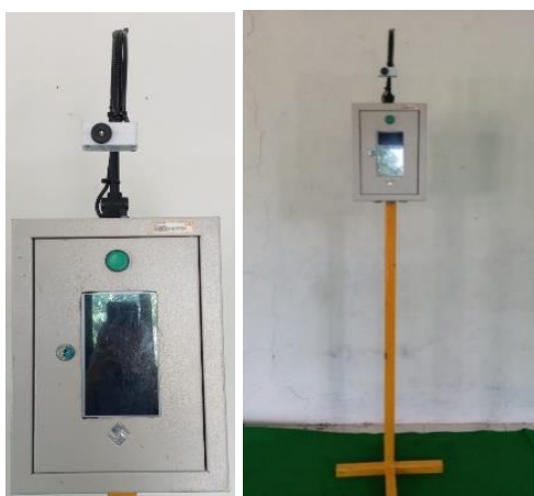
Gambar 5. Panel Box dan Prototype Thermal Camera Detektor
