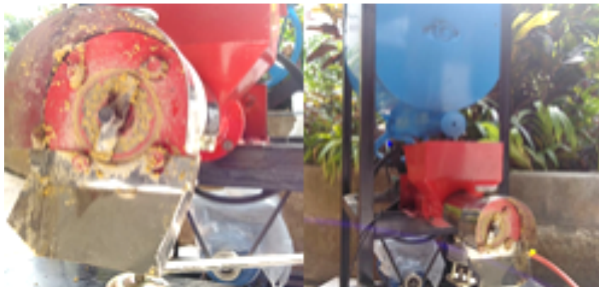
Gambar 2. Bagian pemotong mesin setelah dilakukan proses produksi
