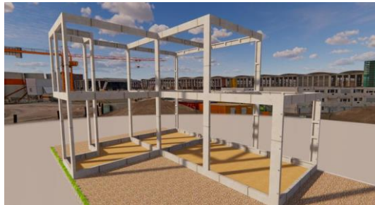
Gambar 4. Pemasangan Panel Struktur RIMAE pada Perencanaan Rumah Hunian Sederhana
