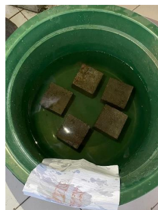
Gambar 1.20 Pengujian Penyerapan Air
