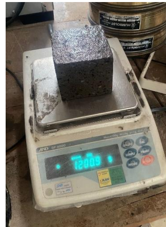
Gambar 1.16 Berat Paving Block 1 setelah di rendam 24 jam
