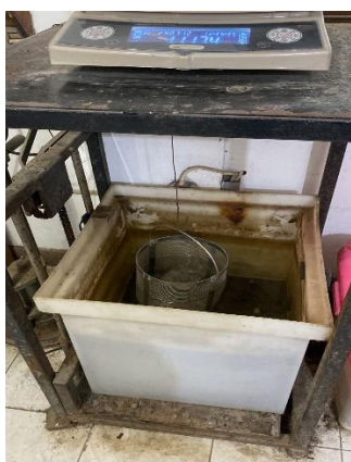
Gambar 1.19 Pengujian Berat Dalam Air
