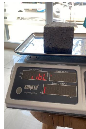
Gambar 1.14 Berat basah Paving Block 2 setelah di rendam 3 mm air
