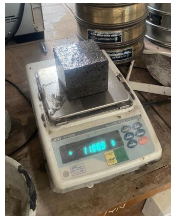
Gambar 1.18 Berat Paving Block 3 setelah di rendam 24 jam
