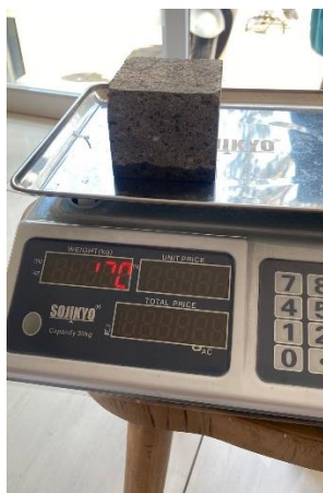
Gambar 1.13 Berat basah Paving Block 1 setelah di rendam 3 mm air
