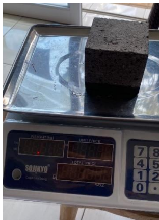
Gambar 1.15 Berat basah Paving Block 3 setelah di rendam 3mm air
