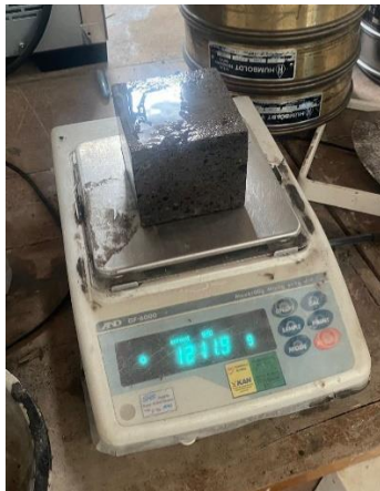
Gambar 1.17 Berat Paving Block 2 setelah di rendam 24 jam
