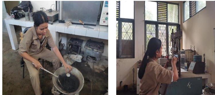
Gambar 6. Campuran beraspal panas dengan alat Marshall
