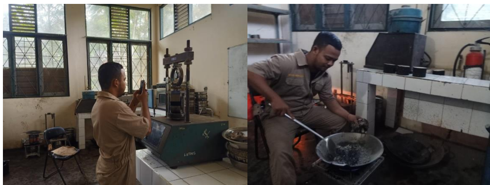
Gambar 3. Campuran beraspal panas dengan alat Marshall
