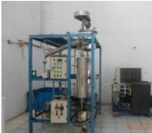
Gambar 1. Unit perengkahan tar batubara
