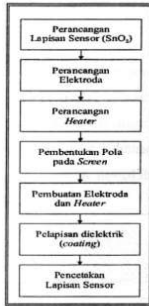
Gambar 2. Tahapan Proses Perancangan dan Fabrikasi Sensor Gas
