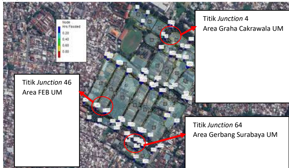
Gambar 5. Hasil Titik Lokasi Banjir Pada Node Flooding yang tampil pada hasil simulasi drainase eksisting tidak mampu mengalirkan seluruh aliran stream curah hujan. Noda banjir atau titik terjadinya banjir dari hasil simulasi perangkat lunak EPA SWMM 5.2 terdapat pada Tabel 13.
