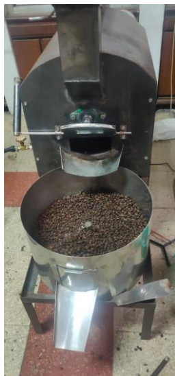
Gambar 3. Mesin Roasting Kopi
